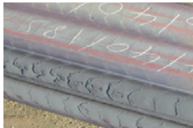
Гребешки/волны на одной из отливок прямоугольного сечения
