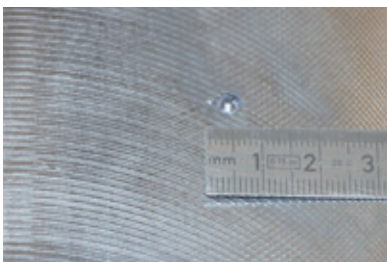
Газовые пузырьки с гладкой глянцевой поверхностью
