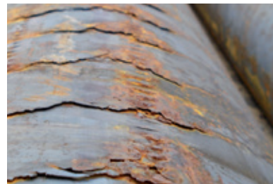
Отслоения на одном из отливок круглого сечения
