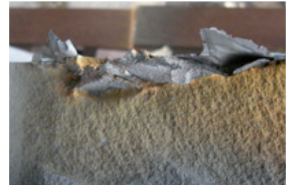
Отслоения на одной из отливок на поверхности
