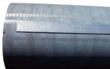
Следы оснастки при протягивания, расположенные параллельно стальному метру.
