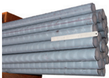
Периодически появляющиеся следы протягивания, замер на расстоянии 55 мм
